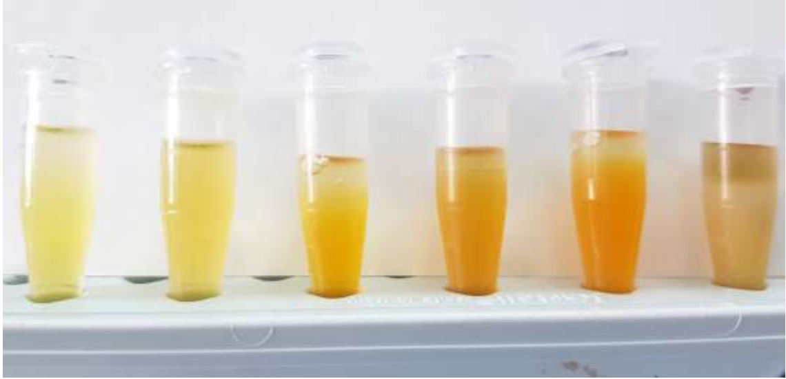
Şekil 3.16. Farklı bakteri izolatlarının amonyak (NH 3 ) üretme potansiyellerinin belirlenmesi. Amonyak üretimi sonrası besi yeri renginin açık sarıdan koyu sarı-kahverengine (soldan sağa) dönüşmesi
