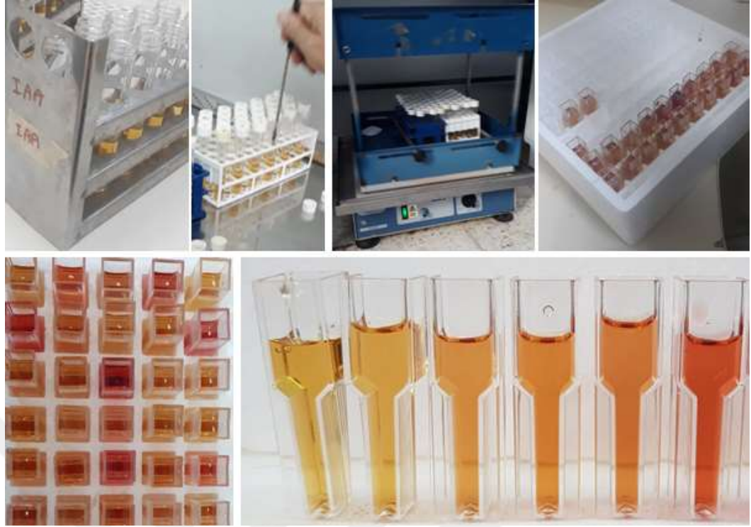
Şekil 3.17. Bakteri izolatlarının tryptophane ihtiva eden Luria-Bertani besi yerinde IAA üretme potansiyellerinin belirlenmesi. Farklı izolatlarca üretilen IAA yoğunluğuna bağlı olarak tüplerde sarı renkten kırmızı pembe renge olan renk değişimleri gerçekleşmiştir
