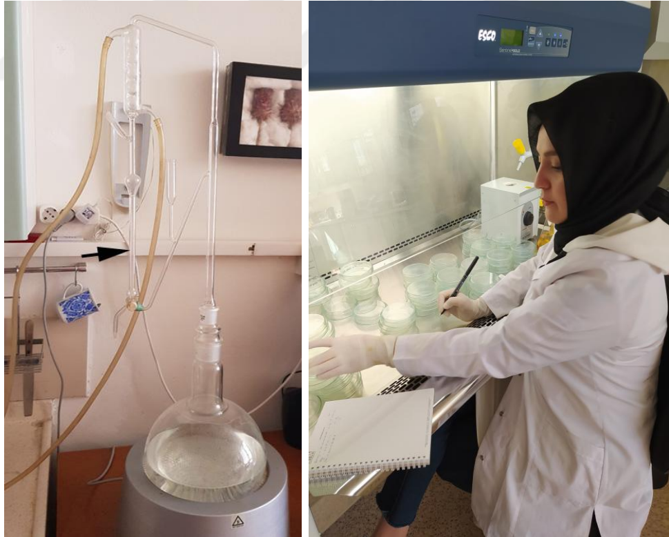
Şekil 3.1. Uçucu yağların çıkartılmasında kullanılan Clevenger tipi yağ çıkarma aleti (İldam, Ankara, Türkiye) ve petri çalışmaları. Ok ile gösterilen yer bitki uçucu yağının toplandığı kısmı göstermektedir.
